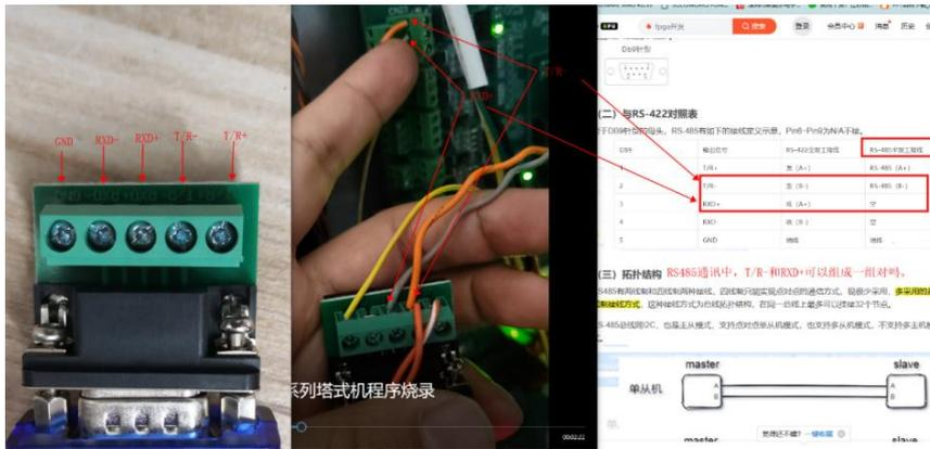
图 2. DB9 连接头实物参考图
